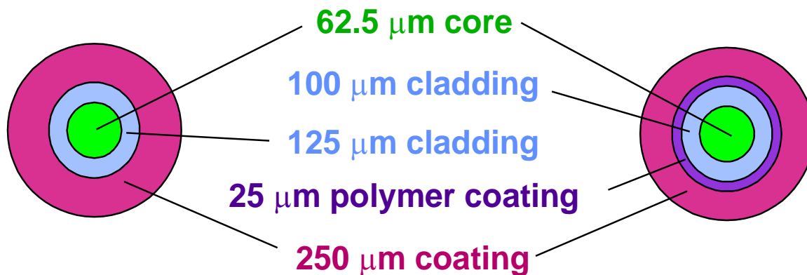
Slika 6. Struktura VOLITION™ optičkih kabela sa povećanom fleksibilnosti
